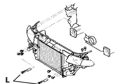
**Stützhülsen.** Bei einigen Autos muss die Vorderwand vorgeschieben werden, um den Zugang zum Motor zu ermöglichen
