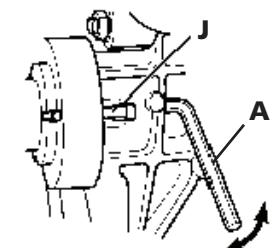
**M5 x 60mm.Schraube** wird verwendet, um die Lüfterkupplung während des Abschraubens mit passendem Sechskantschlüssel zu sichern.
