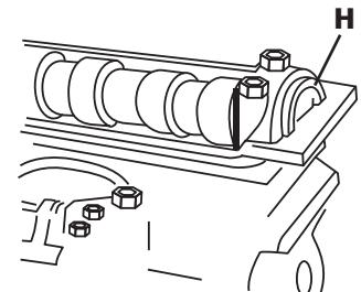
**M5 x 55mm. Stehbolzen und Mutter.** Wird zur Anwendung von Druck auf den Stöbel des Antriebsriemenspanners zum Abbauen der Spannung vom Zahnriemen verwendet.
