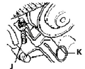
**Fixierstift.** Dieser wird in Verbindung mit der obengenannten Stiftschraube und Mutter verwendet und sperrt den Spannungseinsteller in der eingefahrenen Position, damit der alte Zahnriemen entfernt und der neue Zahnriemen befestigt werden kann.
